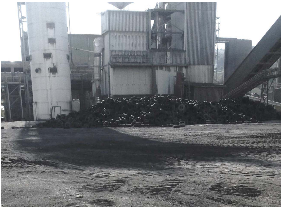
Slika 4. Pripremljene stare gume za upotrebu u rotacionoj peći Figure 4. Prepared old tires for use in rotary kiln
