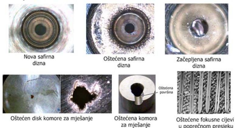
*Slika 8. Oštećenja nastala na safirnoj dizni, disku komore za mješanje, komore za mješanje i fokusne cijevi [5].*
