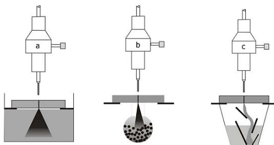
*Slika 4. Shematski prikaz tri osnovna oblika rezervoara [2]
