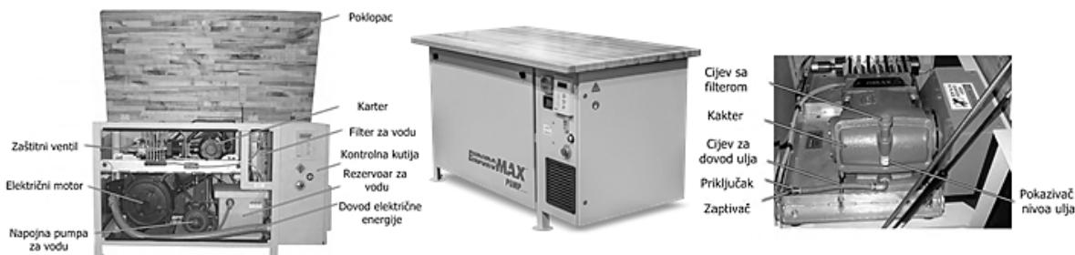
*Slika 5. Osnovne komponente hidraulične pumpe sa radilicom [5]*
