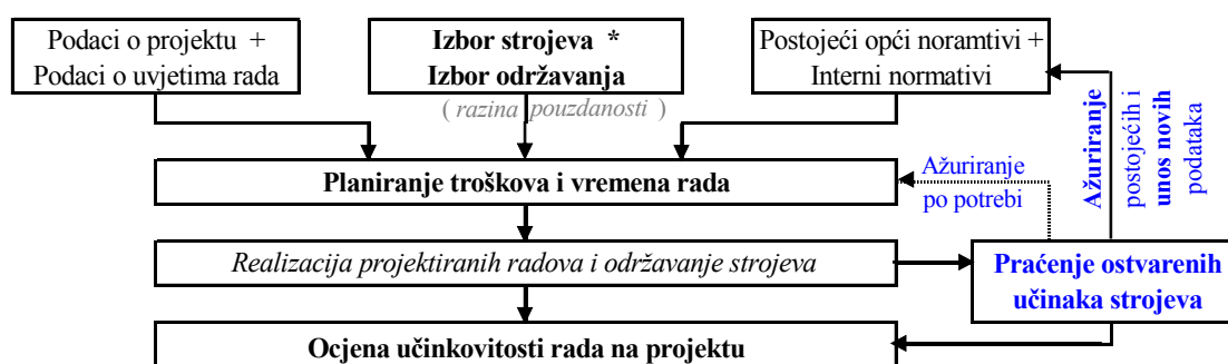
Slika 1. Proces planiranja uporabe građevinskih strojeva
