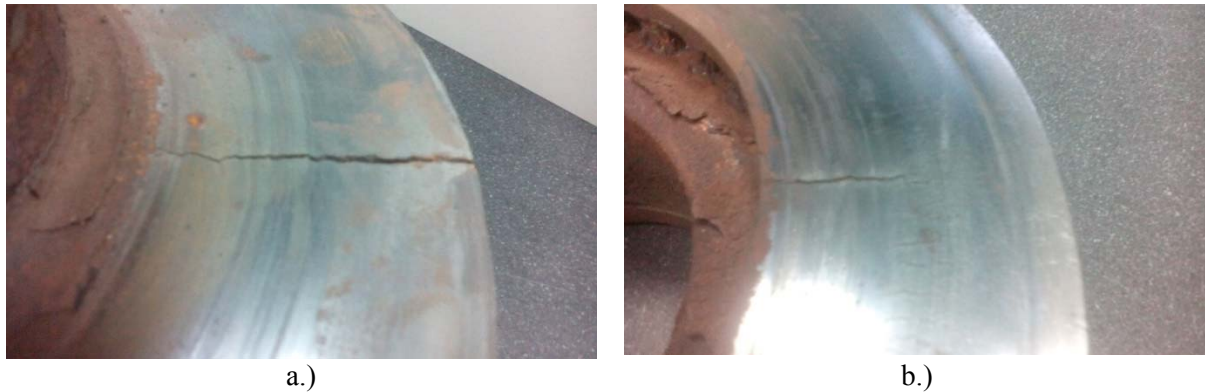
Slika 1. Pukotine na kočionoj površini diska (a – vanjska površina, b – unutrašnja površina) Figure 1. Cracks on braking surface of the disc (a – inner surface, b – outer surface)
