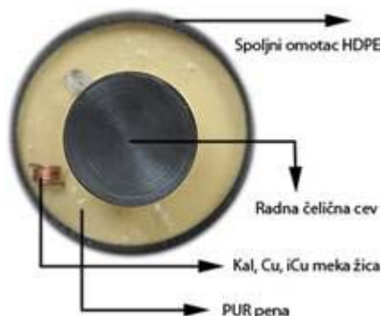
Slika 4. Poprečni presjek PEHD obložene cijevi
