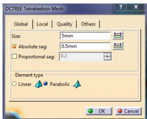
Slika 3. Definisavanje veličine i tipa konačnog elementa kuke
