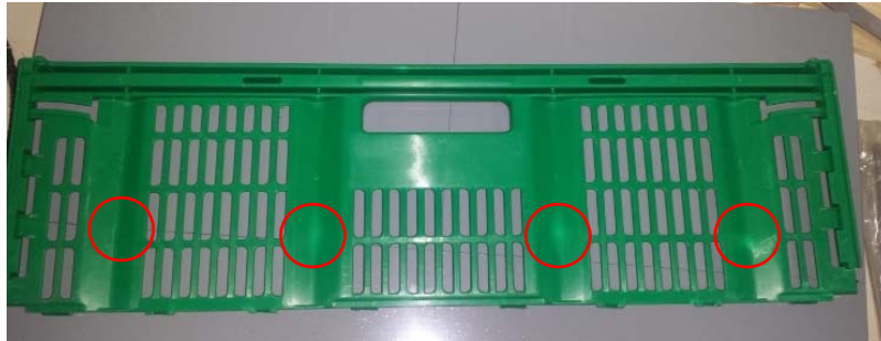
Slika 8. Pozicije na stranici na kojima je došlo do plastične deformacije materijala Figure 8. Places on the container side with the plastic deformation of material
