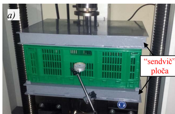
Slika 5. Kontejner tipa T1 a) prije deformacije b) nakon deformacije
