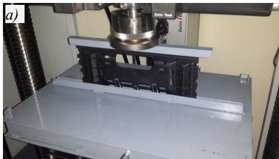
Slika 9. a) Priprema stranice K2 za pritiskanje b) izgled stranice nakon deformacije Figure 9. a) Preparing page K2 for pressing b) appearance after deformation
