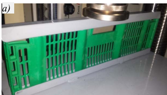
Slika 7. a) Izvijanje stranice T1 i b) dijagram sila-deformacija
