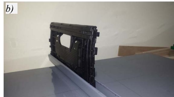
Slika 9. a) Priprema stranice K2 za pritiskanje b) izgled stranice nakon deformacije Figure 9. a) Preparing page K2 for pressing b) appearance after deformation
