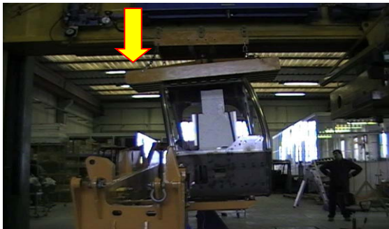
Slika 5. Ispitivanje okomitom silom a) početak ispitivanja, b) završetak ispitivanja [8] Figure 5. Vertical force testing a) start of testing b) end of testing [8]
