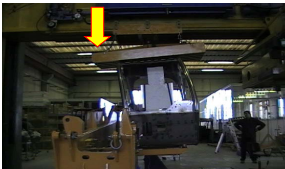
Slika 5. Ispitivanje okomitom silom a) početak ispitivanja, b) završetak ispitivanja [8] Figure 5. Vertical force testing a) start of testing b) end of testing [8]
