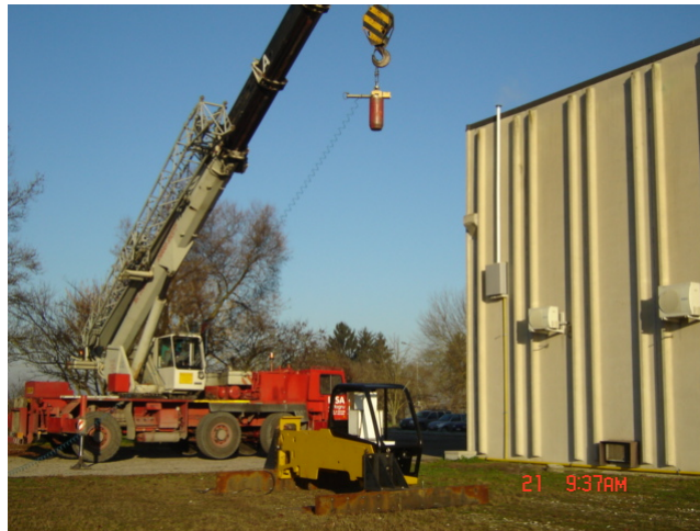
Slika 8. FOPS ispitivanje strukture [8] Figure 8. FOPS Structure testing [8]
