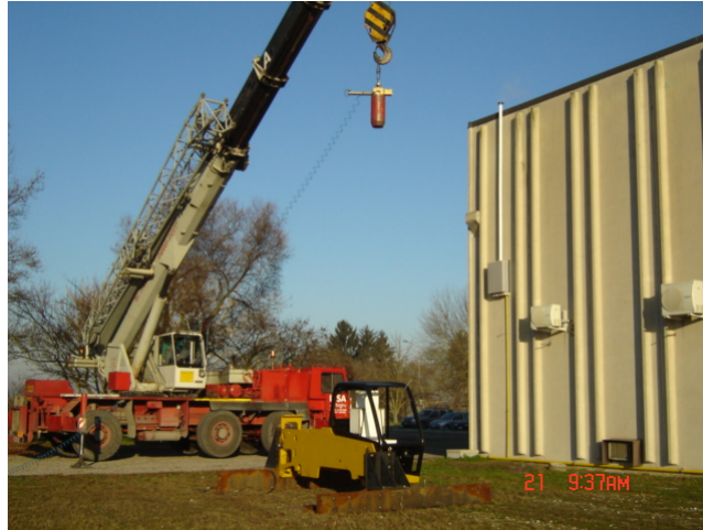
Slika 8. FOPS ispitivanje strukture [8] Figure 8. FOPS Structure testing [8]
