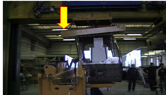
Slika 5. Ispitivanje okomitom silom a) početak ispitivanja, b) završetak ispitivanja [8] Figure 5. Vertical force testing a) start of testing b) end of testing [8]
