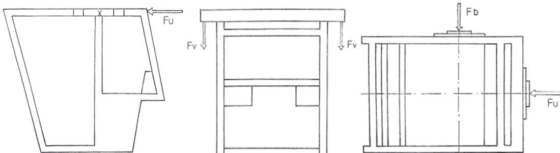
**Slika 3. Mjesto i pravac dejstva opterećenja pri bočnom, vertikalnom i uzdužnom opterećenju [5]**
