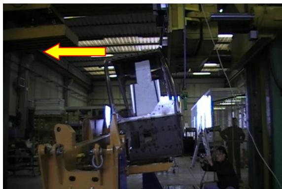
**Slika 4.** Ispitivanje bočnom silom a) početak ispitivanja, b) završetak ispitivanja [8]
