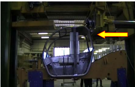
Slika 6. Ispitivanje uzdužnom silom a) početak ispitivanja, b) završetak ispitivanja [8] Figure 6. Longitudinal force testing a) start of testing b) end of testing [8]
