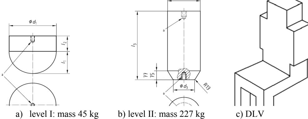
*Slika 7. Fops ispitivanje a) i b) Standardne dimenzije padajućih predmeta za ispitivanje,
