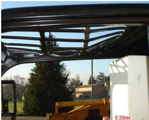
Slika 9. Ispitivanja FOPS metodom [8] Figure 9. FOPS method testing [8]
