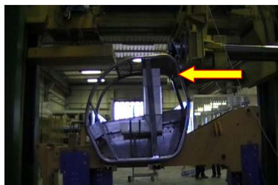
**Slika 6.** Ispitivanje uzdužnom silom a) početak ispitivanja, b) završetak ispitivanja [8]
