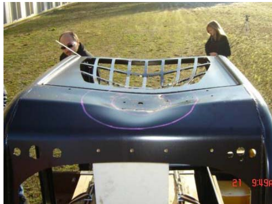
Slika 9. Ispitivanja FOPS metodom [8] Figure 9. FOPS method testing [8]
