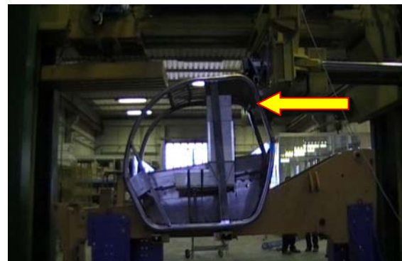
Slika 6. Ispitivanje uzdužnom silom a) početak ispitivanja, b) završetak ispitivanja [8] Figure 6. Longitudinal force testing a) start of testing b) end of testing [8]
