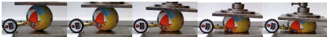
Slika 4. Test na pritisak s mjerenjem pritiska u lopti [1] Figure 4. Compression test with pressure measurement [1]
