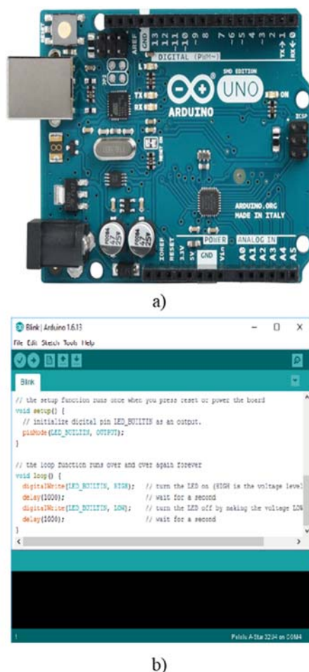
Figure 5 Microcontroller Arduino Uno Rev3 a) Arduino UNO, b) Software Arduino IDE
