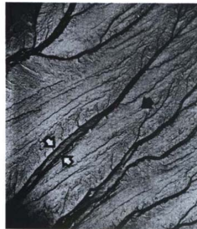
Slika 4. Interkristalni krti lom, čelik 4340 (a) i transkristalni krti lom, legura Alnico (b), TEM-replike [5]
