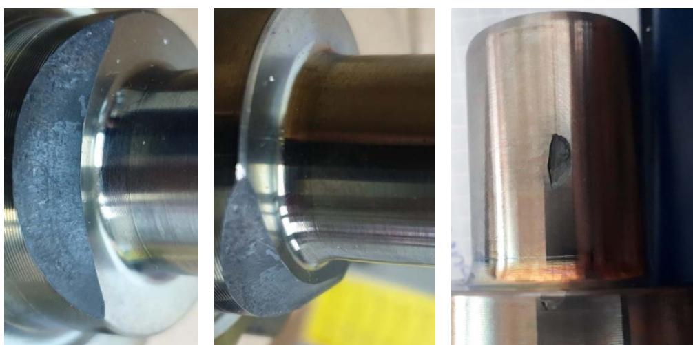
*Slika 3. Izgled dijelova sa greškom nakon obrade struganjem
