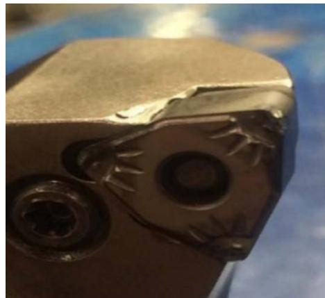
*Slika 4. Izgled polomljenog vrha pločice
