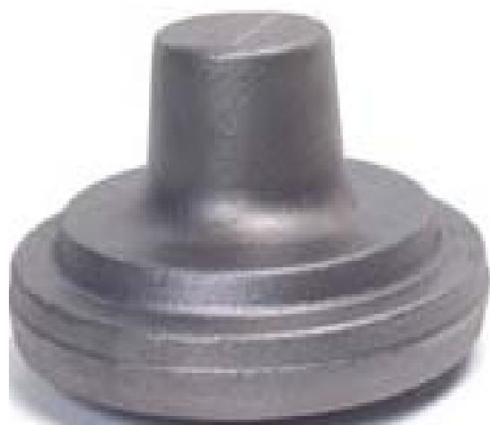
*Slika 1. Otkovak za izradu rukavca točka motornog vozila*
