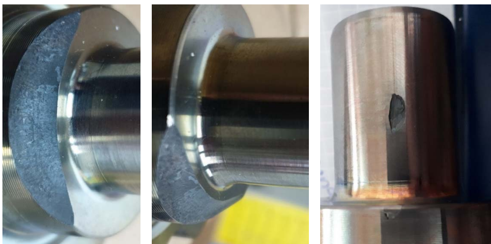
Slika 3. Izgled dijelova sa greškom nakon obrade struganjem
