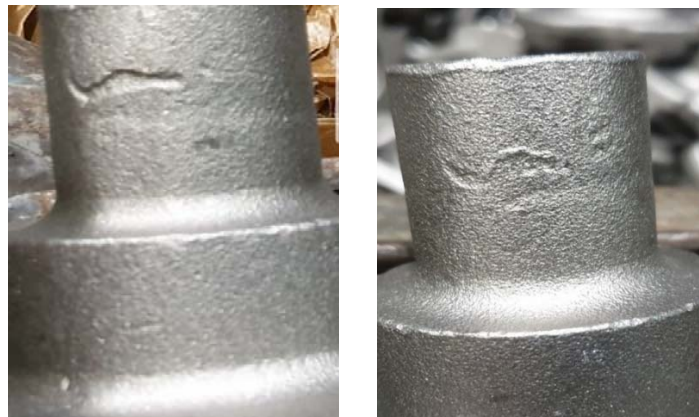
Slika 2. Izgled otkivka sa greškama otkrivenim vizualnom metodom
