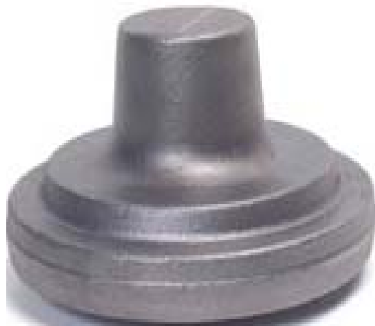
Slika 1. Otkovak za izradu rukavca točka motornog vozila
