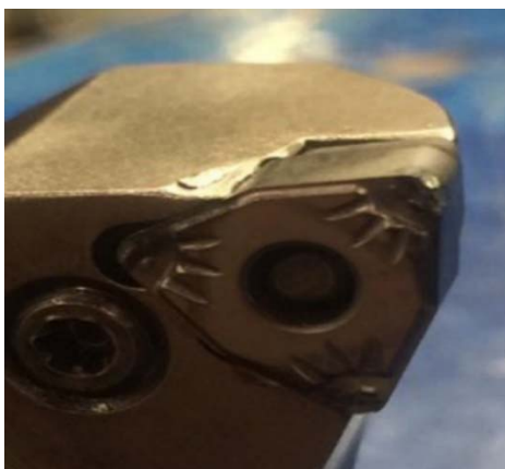
Slika 4. Izgled polomljenog vrha pločice Figure 4. The appearance of the broken top of the tile
