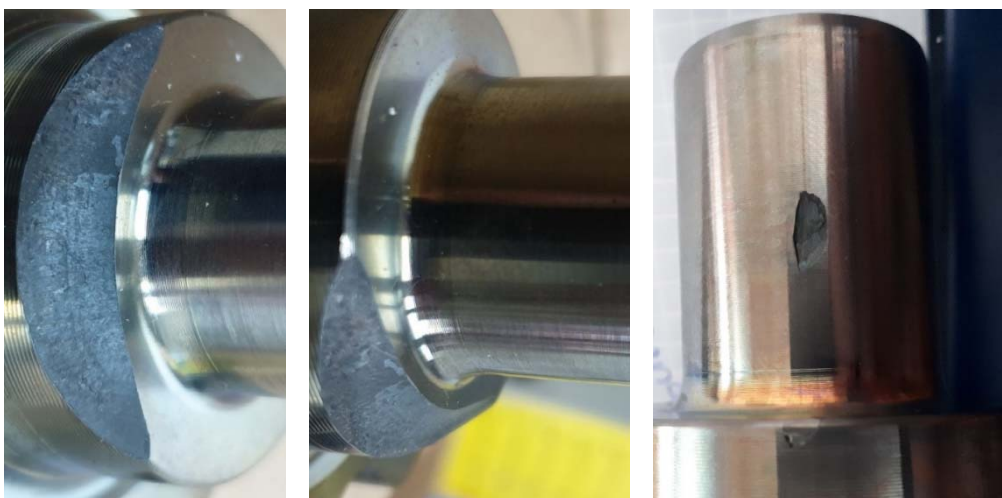
Slika 3. Izgled dijelova sa greškom nakon obrade struganjem
