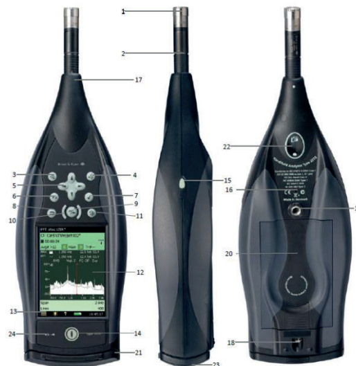
Slika 2. Komponente instrumenta, [1] Figure 2 Instrument components [1]
