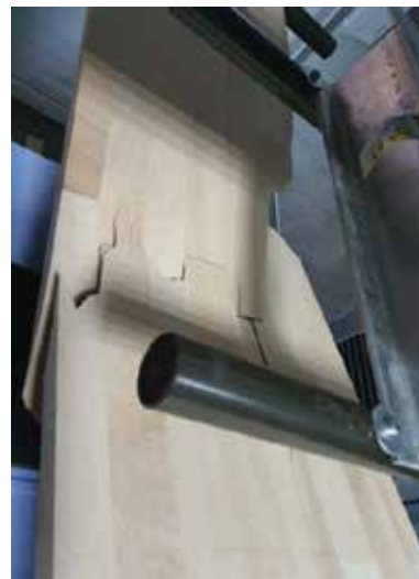
Slika 3. Savijanje ploče prema standardu BAS EN 789
