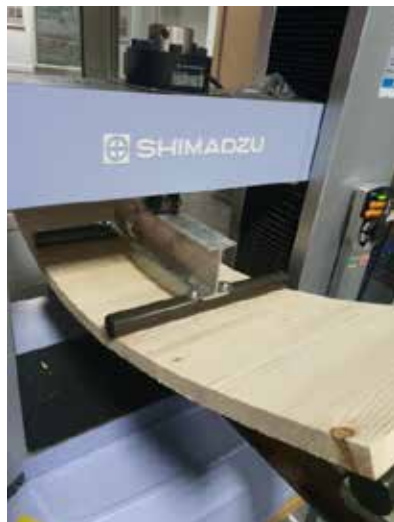
Slika 3. Savijanje ploče prema standardu BAS EN 789
