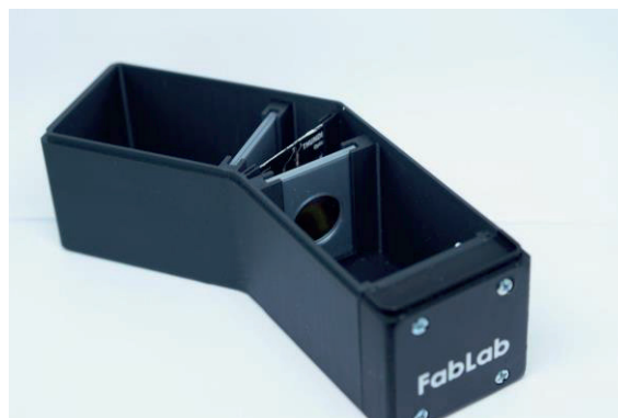
Slika 4.2 Unutrašnjost spektrometra Figure 4.2 Inside of the spectrometer
