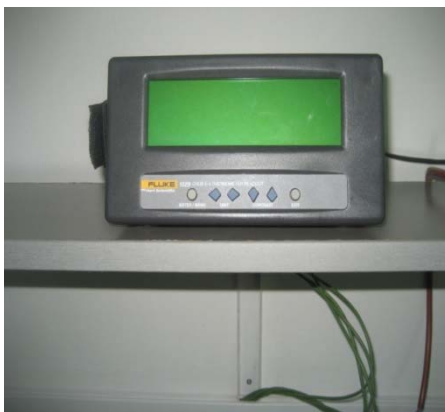
Slika 6. Digitalni termometar Chub-E4 na koji su prikopčani termoelementi za praćenje temperature unutar referentnog tijela za ekstrapoliranje
