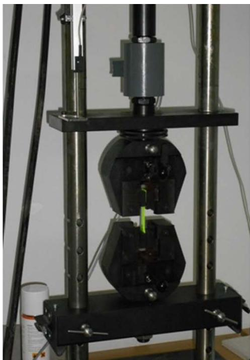
*Slika 3. Ispitivanje na zatezanje
