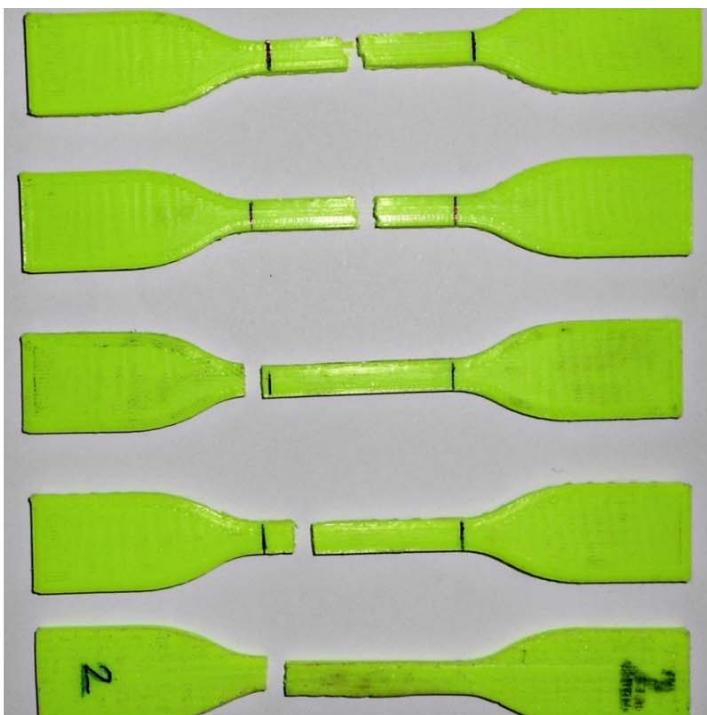
*Figure 4. Epruvete nakon ispitivanja na kidalici
