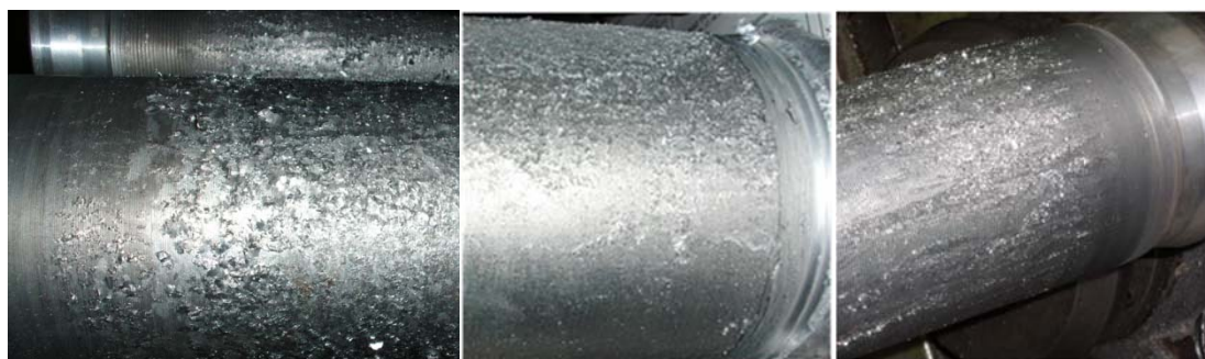
Slika 10. Odvajanje sitnih čestica od izradaka iz Al 99,5 pri IHRI Slika 10. Separation of small particles of workpieces from Al 99.5 during the FCFF
