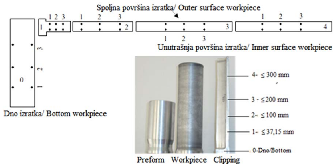
Slika 8. Položaj mjernih mjesta za mjerenje tvrdoće po dužini izradaka Figure 8. Location of measurement points for measuring the hardness lengthwise of workpieces
