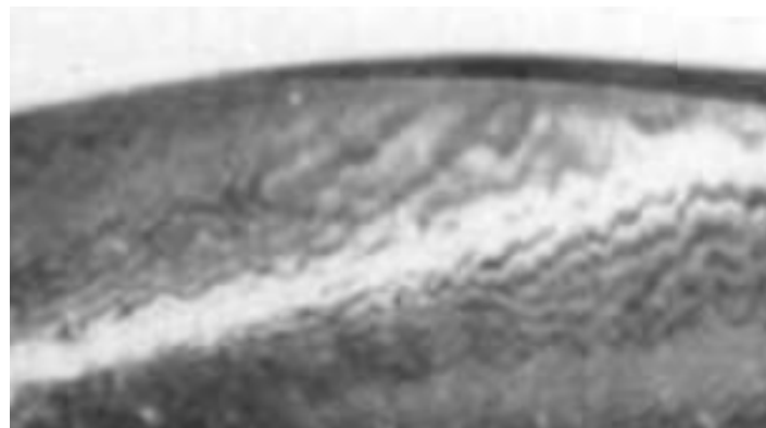
Slika 5. Naborana površina zupca Figure 5. Rippled surface of teeth
