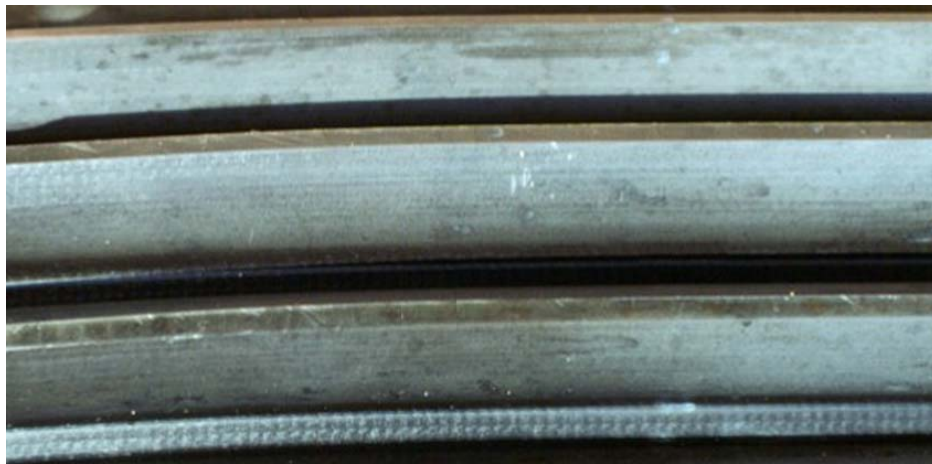
Slika 4. Deformacija (savijanje) zubaca zupčanika Figure 4. Deformation (bending) gear tooth
