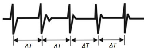
Slika 14. Vremenski dijagram vibracija pri slomljenom zupcu
